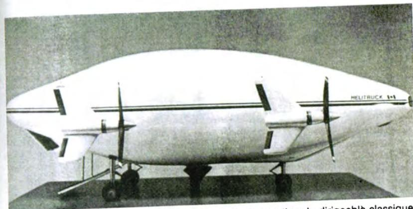
Photo 7.3 - Le Vivan Hybrid V/STO4, une nouvelle conception du dirigeable classique : structure rigide remplie d'hélium, moteurs d'avion, faculté de vol stationnaire comme l'hélicoptère, vitesse pouvant atteindre... 275 km/h !
