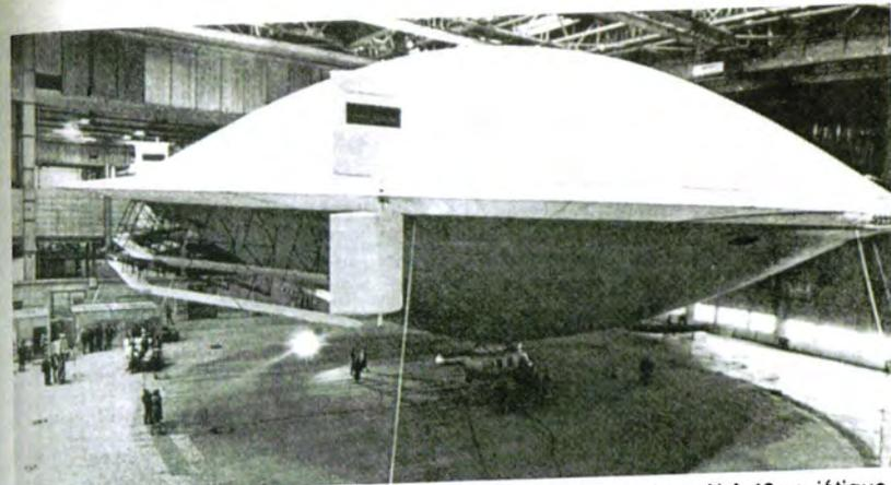
Photo 7.2 - Une "soucoupe volante" bien terrestre : le Thermoplane ALA-40 soviétique.
